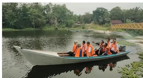
Gambar: Produk Inovasi Skala Industri, Kapal teknologi komposit kayu laminasi berukuran 3GT yang siap digunakan yang dibuat dengan mengandalkan tenaga lokal
