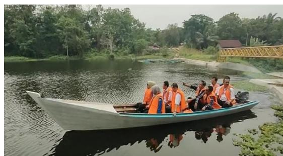
Gambar: Produk Inovasi Skala Indutri, Kapal teknologi komposit kayu laminasi berukuran 3GT yang siap digunakan yang dibuat dengan mengandalkan tenaga lokal
